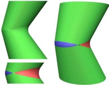
Figura 5. Superficies de redondeo en unión cóncavo / convexo.
