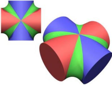
Figura 4. Superficies de redondeo en la intersección de dos cilindros.
