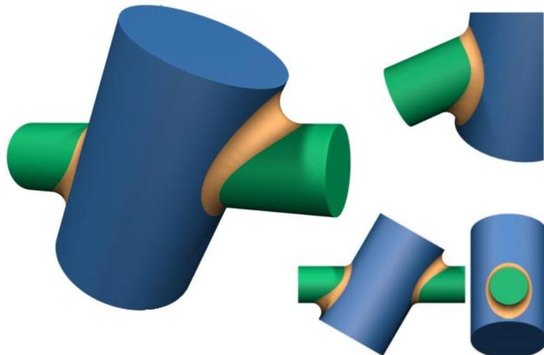
Figura 3. Superficie de redondeo en la intersección entre dos cilindros de distinto diámetro.
