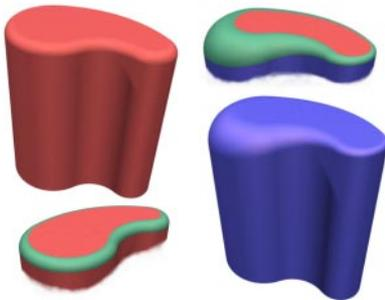
Figura 2. Unión entre un plano y una superficie cilíndrica con una superficie de radio constante y con una de radio variable.
