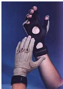
Figura 3- As luvas instrumentadas usadas em realidade visual vêm ganhando popularidade como dispositivos de entrada de dados em 3D real.
