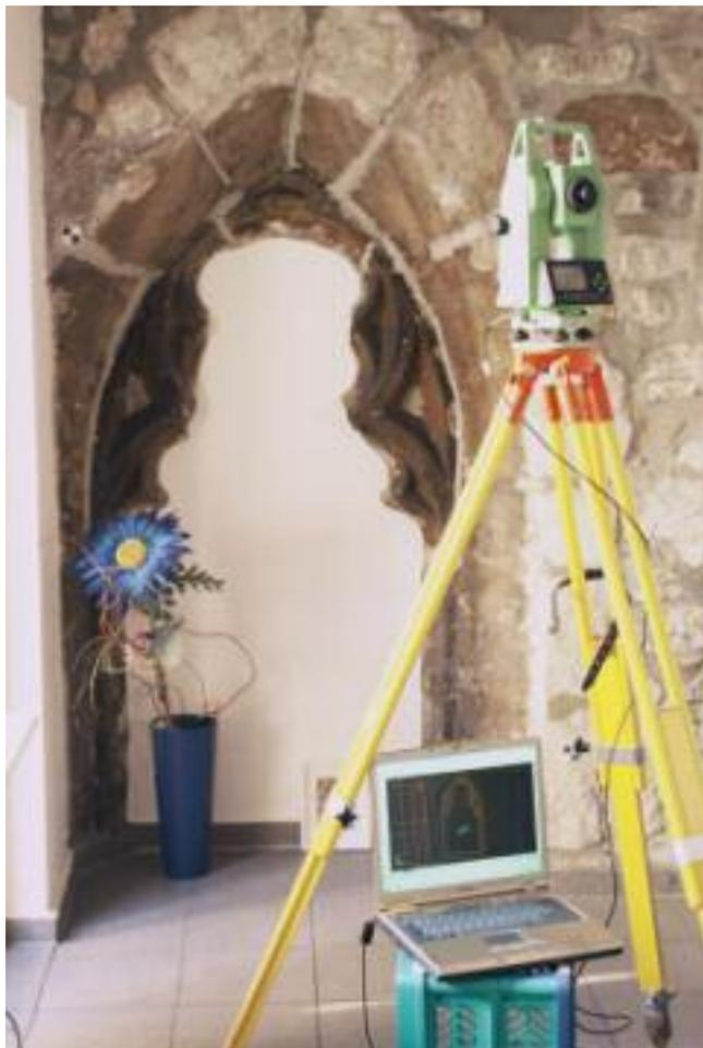
Abb. 17: Onlineübertragung der Meßwerte. Durch die Übertragung der Meßwerte an ein CAD-System, können die erfaßten Bauteilgeometrien sofort sichtbar gemacht werden. Grobe Fehler und Lücken in der Erfassung können dadurch vermieden werden.
