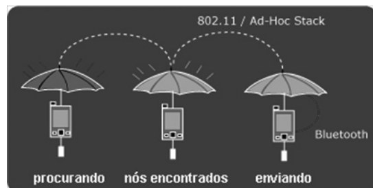
figura 1: diagrama do sistema individual umbrella.net, nomeando cada componente de hardware.
